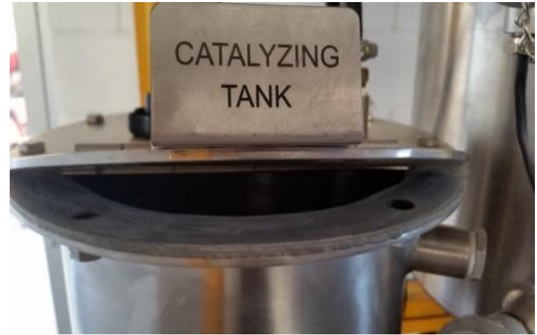
Figura 4. Colocación de la mezcla en tanque para reactivos..
