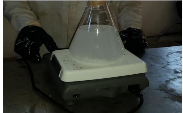
Figura 3. Mezclado de hidróxido de sodio con metanol.
